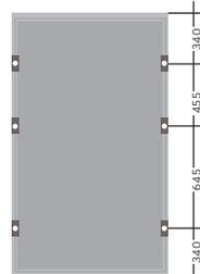
Bei dieser Montagevariante kann durch die hohe Last das Modul in Berührung mit den Montageschienen kommen. Zur Vermeidung von Glas-Schäden ist deshalb eine Gummierung auf den Schienen vorzusehen.
