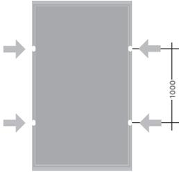
Platzieren Sie die Klemmen an den Positionen der Rahmenbohrungen!
