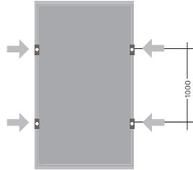
Max. zulässige Drucklast bis 6.750 Pa (Testlast 10.125 Pa)
