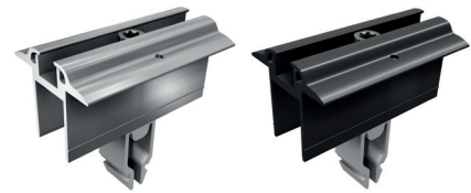
Mittelklemmen Vario mit Erdungspin für Rahmenhöhe 30 mm - 50 mm
