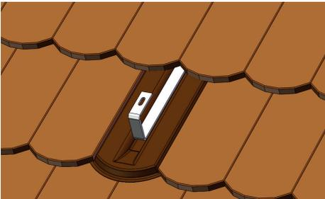
Entnahme des Ziegels und Montage des Dachhakens auf dem Sparren mittels Zweier Holzschrauben.
