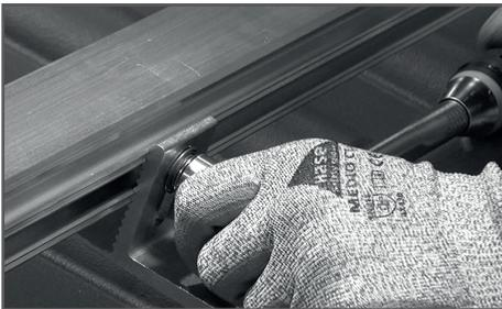
Wenn alle Profile ausgerichtet sind, Mutter mit Drehmomentschlüssel anziehen.
