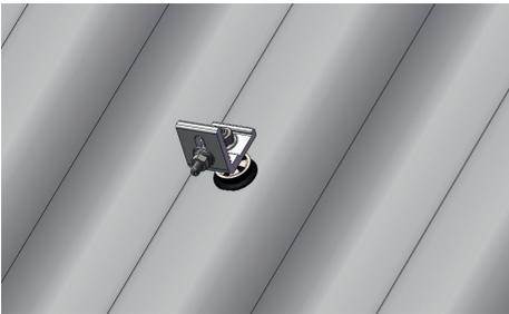
Anschrauben des Adapterwinkels und Verschraubung mit Kontermutter.
